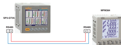
Comunicación con analizador de redes
